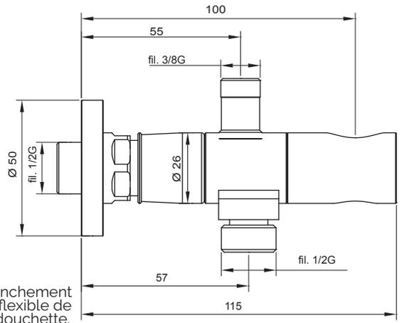
Possibilité d'installation à droite ou à gauche du réservoir des toilettes
